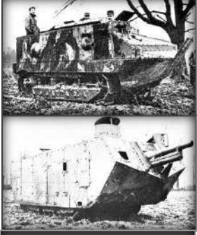
a) 8,1 km hız ulaşabilen Schneider tankı. b) 23 ton ağırlığına oranla küçük paletleriyle dikkat çeken, 12 km hız ulaşabilen St. Chamond
